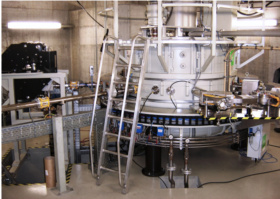
Rhodotron von Synergy Health: Beschleunigt Elektronen, die auf ein Tantal-Target geschossen werden, wobei harte Röntgenstrahlung entsteht, die zur Desinfektion genutzt wird. (Bild: Synergy Health)
